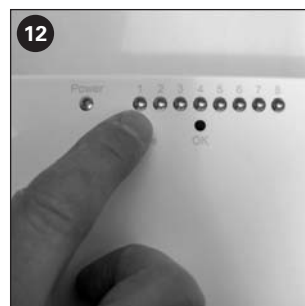
12 Afbryd installationsmode og gå til normal drift ved at holde Toggle nede i 3 sekunder. (Sker automatisk ved installation af alle kanaler.)
