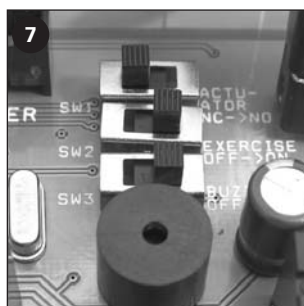
7 Vælg system-indstillinger på de tre skydeswitche. Luk låget og spænd de tre skruer.
