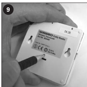
9 Send et "Installationssignal" fra rumtermostaten ved at trykke med et kort tryk (1 sekund) på knappen bagpå med en kuglepen.
